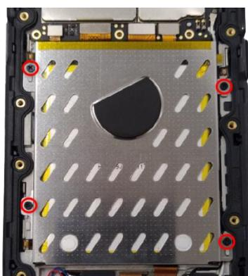
Avant de positionner la nouvelle batterie, vérifier que l'emplacement soit parfaitement propre et lisse (aucun pli sur l'adhésif, aucun corps étranger tel qu'une vis).
