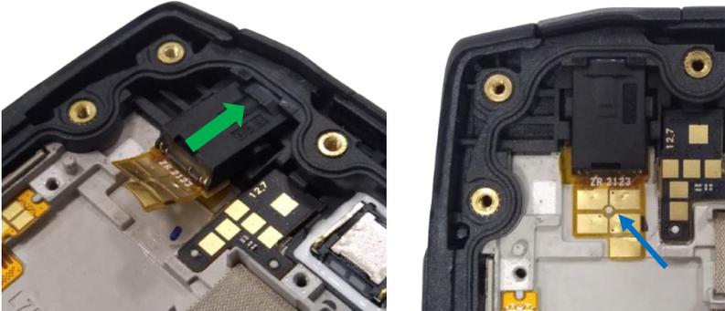
Insérer le connecteur jack dans le sens indiqué par la flèche verte. Plaquer le connecteur et les contacts. Vérifier que l'ergot coïncide avec le trou sur le flex (flèche bleue).
