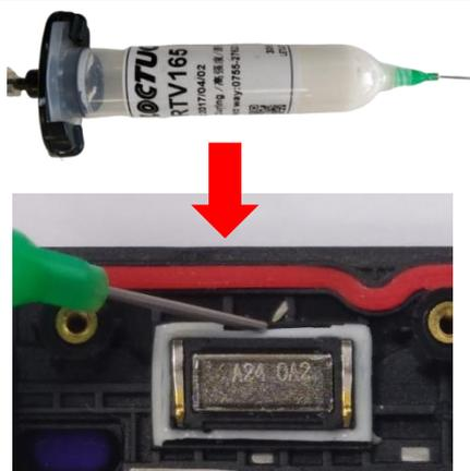
Appliquer du joint silicone LOCTUO RTV165 (produit conseillé – non vendu par CROSSCALL) autour de l'écouteur, laisser sécher quelques minutes avant remontage du produit.
