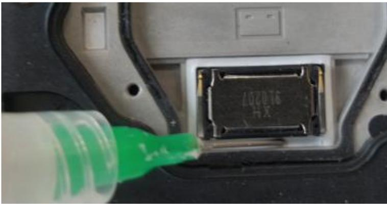
Appliquer du joint silicone LOCTUO RTV165 (produite conseillé - non vendu par CROSSCALL) autour de l'écouteur, laissez sécher quelques minutes avant remontage du produit.
