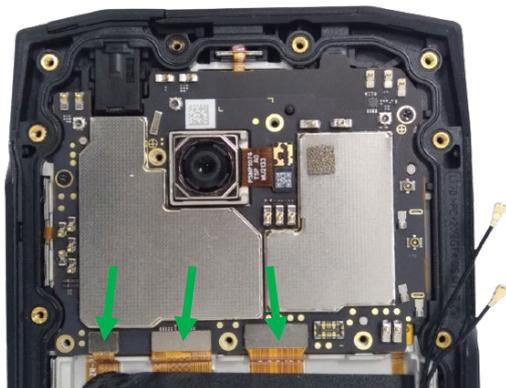
Connecter les 3 flex repérés par une flèche verte.
