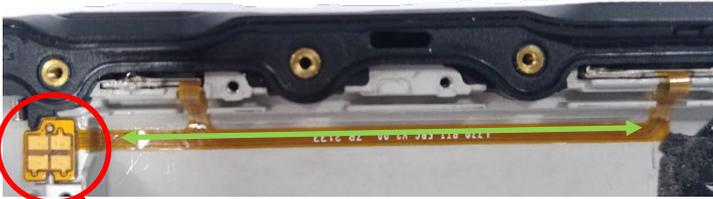
Coller les contacts du flex en faisant coïncider les 2 plots de guidage sur la cosmétique avec les trous sur le flex (flèches bleues).
