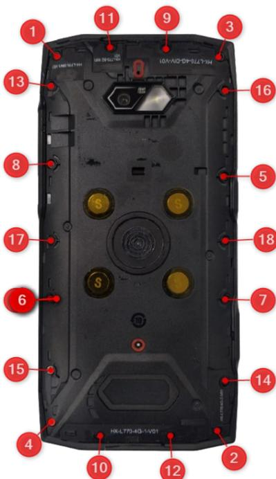
Vissez les 18 vis M1.5x5F avec la visseuse ou le tournevis dynamométrique réglés au couple suivant :
