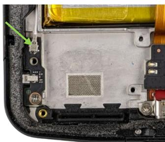
Brancher le connecteur du câble coaxial.
