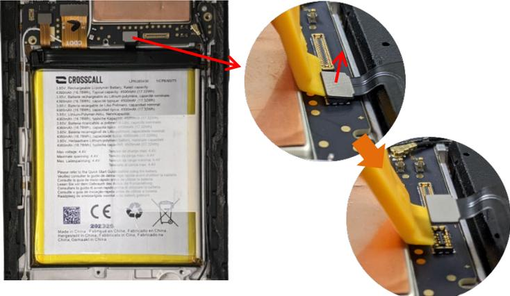
Débranchez le connecteur batterie en le soulevant à l'aide d'un outil de démontage non métallique.
