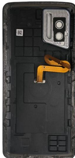
Débrancher le connecteur du flex magnétique à l'aide d'un outil plastique.
