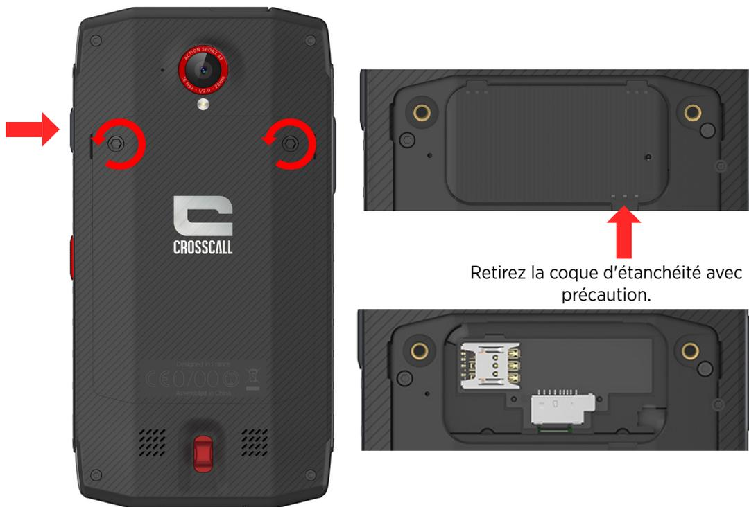
**Avertissement :** faites attention à l'antenne lorsque vous retirez la coque d'étanchéité. Veuillez ne pas utiliser d'outil pour retirer la coque d'étanchéité, afin de ne pas endommager le joint en caoutchouc.
