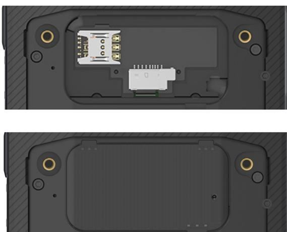
Après avoir installé les cartes correctement, appuyez fermement sur la coque d'étanchéité.
