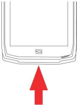
1. Ouvrez le cache d'étanchéité et raccordez le câble et l'adaptateur secteur fourni dans votre pack via le port USB-A. Branchez ensuite l'autre extrémité du câble dans le port USB-C de votre téléphone.
