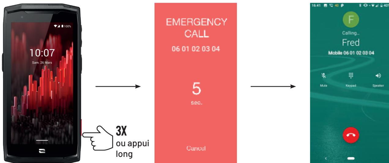
Nous vous conseillons vivement de lancer une alerte afin de vérifier que la configuration de votre application X-SAFE est opérationnelle. Un compte à rebours est lancé. L'utilisateur peut interrompre l'alerte en appuyant sur le bouton «Annuler». À la fin du compte à rebours, un appel et/ou SMS est automatiquement envoyé à la personne sélectionnée au préalable.
