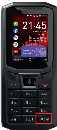
Dolgo pritisnite tipko # za preklop iz načina vibriranja v način zvonjenja in obratno.
