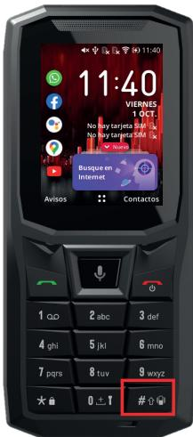
Pulse de manera prolongada la tecla # para pasar del modo de vibración al de timbre y viceversa.
