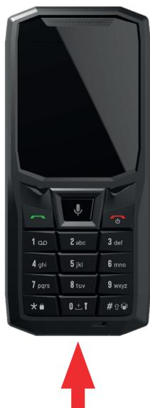
1. Abra a tampa anti-poeira e ligue o cabo e o adaptador de alimentação fornecido no seu pack através da porta USB-A. Ligue depois a outra extremidade do cabo à porta micro USB do seu telefone.
