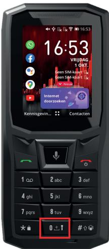
In het startscherm houdt u toets 0 langdurig ingedrukt om de zaklamp in te schakelen/uit te zetten.
