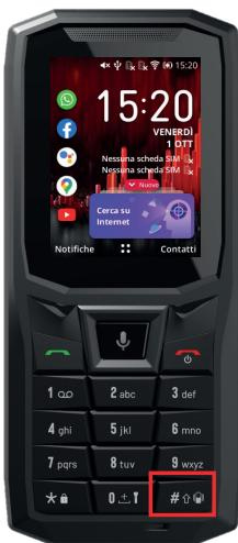
Premere a lungo il tasto # per passare dalla modalità vibrazione alla modalità suoneria e viceversa.
