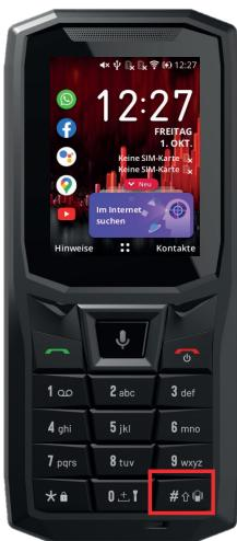
Drücken und halten Sie die Taste #, um zwischen Vibrations- und Klingeltonmodus zu wechseln.
