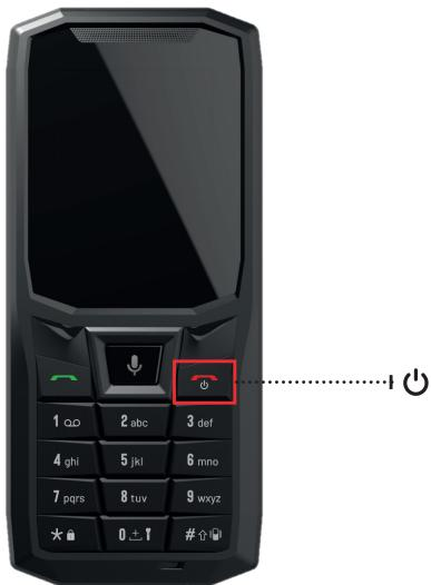
Halten Sie die **Ein-/Aus-Taste** des Telefons gedrückt und warten Sie einige Sekunden, bis sich das Display einschaltet.
