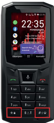
Snimku zaslona možete izvršiti istovremenim pritiskom tipki \* i # na telefonu.
